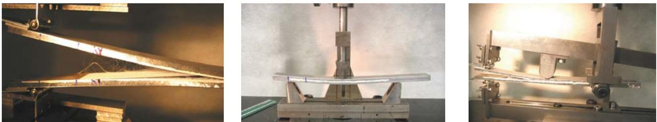
Abb. 2: FML Rissfortschrittsprüfungen zur Bestimmung der Materialparameter des Delaminationsmodells (von links nach rechts): Mode I (DCB), Mode II (ENF), Mixed Mode I/II (MMB)
