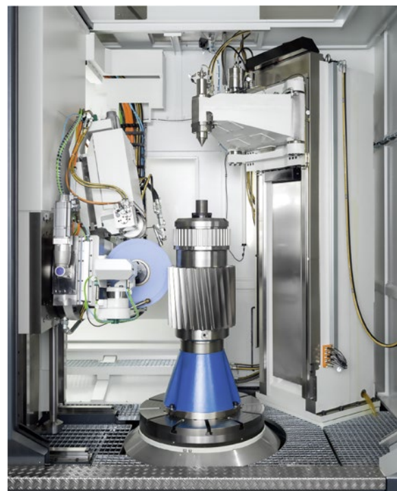
Neue Profilschleiflösungen sind von zentraler Bedeutung, um die für heutige Windkraftgetriebe erwartete Qualität und Zuverlässigkeit zu erzielen und zugleich die Zykluszeiten zu verringern. Bilder: Gleason Corporation
